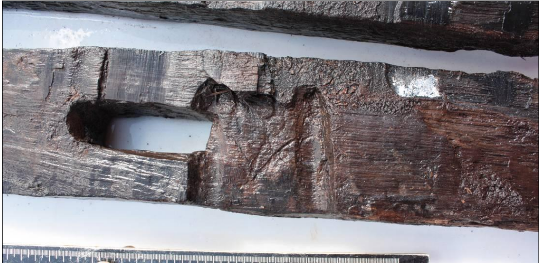
Figuur 4 Oss-Padihoeve, vondstnummer 75B, doorsnede van een recent gespleten hoekstaander met boorgaten (© BIAAX Consult).
