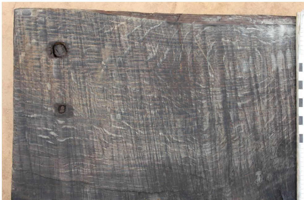
Figuur 7 Panningen-Industrieterrein, eikenhouten plank met schuine zaagsporen van een raamzaag, vondstnummer 89 (©BIAX Consult).
